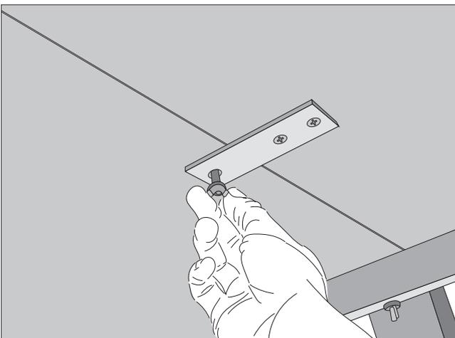
3. Ansatzplatte mit kleinerer Flügelmutter fixieren
