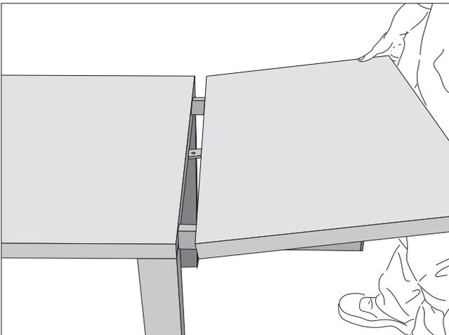
2. Ansatzplatte auf Edelstahlschienen auflegen und ausrichten
