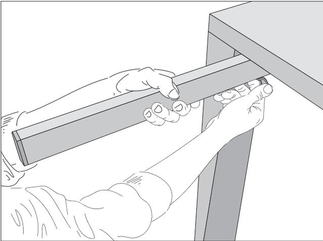
1. Edelstahlschienen mit den großen Flügelmuttern befestigen (kurze Seite in Richtung Tisch)
