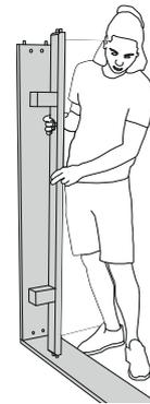
**3.** Die BettfüÙe auf die Quertraversen aufstecken und diese an der Bettseite montieren.
