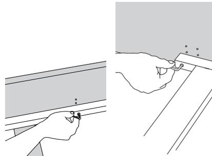
**5.** Seitliche Halteleisten und Mittelsteg mit den Confirmatschrauben befestigen.
